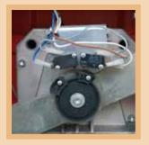
Trois micro-interrupteurs garantissent la précision des mouvements et des fermetures parfaites
